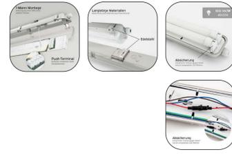
Feuchtraum-Wannenleuchten mit bereits verbauten und auswechselbaren LED-Röhren in 4000K. PC-Gehäuse mit Edelstahlklemmen, Schutzklassen IP65 und IK10, Schnelle 1-Mann-Montage, Installation mit Steckklemme und Durchgangsverdrahtung. Inklusive Montagematerial.
